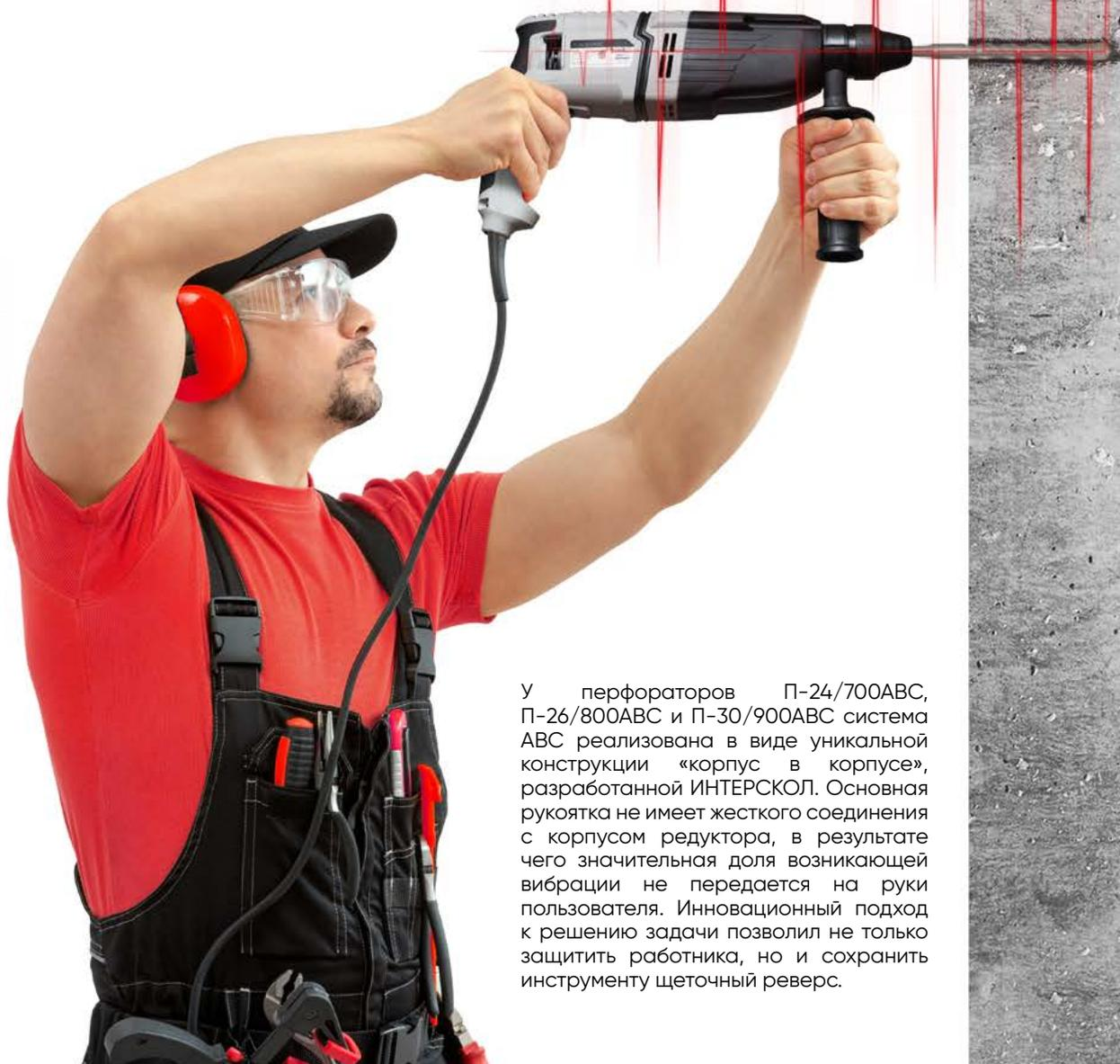
У перфораторов П-24/700ABC, П-26/800ABC и П-30/900ABC система ABC реализована в виде уникальной конструкции «корпус в корпусе», разработанной ИНТЕРСКОЛ. Основная рукоятка не имеет жесткого соединения с корпусом редуктора, в результате чего значительная доля возникающей вибрации не передается на руки пользователя. Инновационный подход к решению задачи позволил не только защитить работника, но и сохранить инструменту щеточный реверс.
